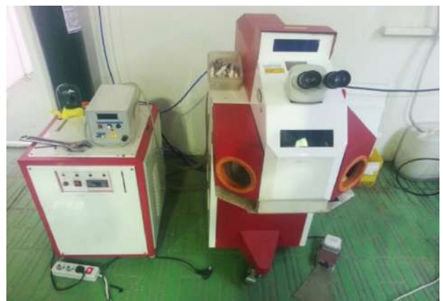
شکل 2- دستگاه جوش لیزر پالسی
