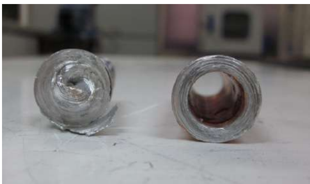
شکل 16- نحوه شکست نمونه‌های گروه سوم
