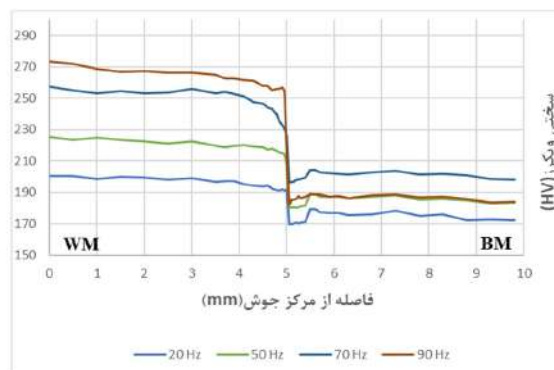
شکل ۵- پروفیل ریزسختی بر حسب فاصله از مرکز جوش در فرکانس های مختلف
