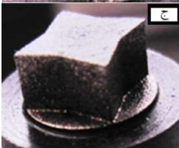
شکل ۱- ابزار جوشکاری همزن اصطکاکی با هندسه پین، الف) مثلثی شکل پین رزوه‌دار - شانه همراه با انحنا ب) ستاره‌ای شکل بدون رزوه - شانه بدون انحنا ج) پین بدون رزوه - شانه همراه با انحنا.
