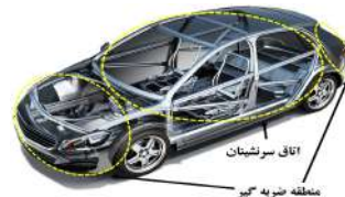
شکل ۱- قسمت‌های اصلی بدنه خودرو در هنگام تصادف (ضربه گیر عقب و جلو و اتاق سرنشینان).
