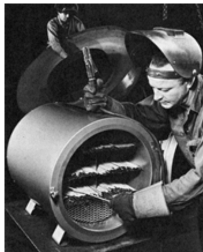
شکل ۳- جوشکار از الکتروودهای پخت شده در Oven مستقیماً استفاده می کند یا مقداری از الکتروودهای پخت شده را داخل گرمکن می گذارد و از آن استفاده می کند.
