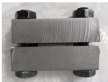
شکل ۱- نمونه های قرار گرفته داخل فیکسچر
