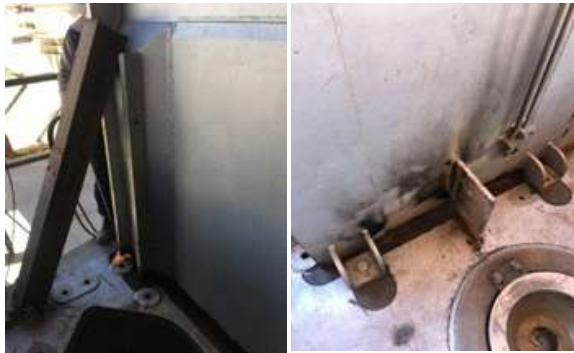
شکل ۳- فیکس شدن قطعه کار توسط تک زنی لچکی ها و ساپورت ها جهت شروع جوشکاری.
