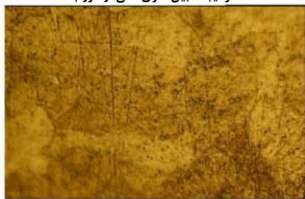
شکل ۴- ساختار در ناحیه دیگر نمونه و مشاهده تجمع ذرات ترکیبات بین فلزی غنی از کروم
