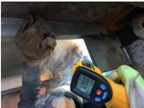
شکل ۴- انجام کنترل دمای پیش گرم و بین پاسی طبق دستورالعمل توسط ترمومتر لیزری.
