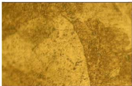
شکل ۳- ساختار در ناحیه دیگر نمونه و مشاهده تجمع ذرات ترکیبات بین فلزی غنی از کروم
