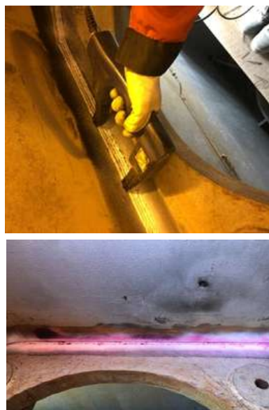
شکل ۵- انجام آزمون مایع نافذ برای پاس ریشه و سپس آزمون ذرات مغناطیسی در اتمام عملیات جوشکاری.
