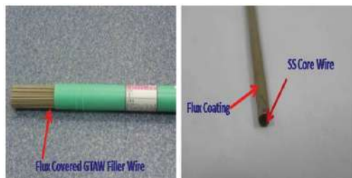
شکل ۳- سیم جوش روکش شده برای GTAW
