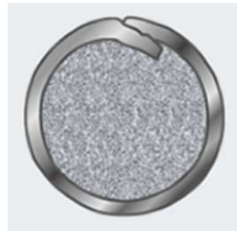
شکل ۱- مقطع عرضی سیم جوش توپودری برای فولاد زنگ نزن آستنیتی
