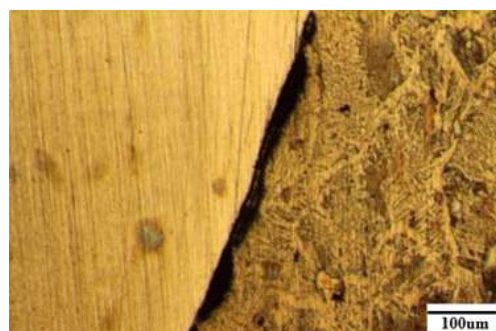
شکل ۵- تصویر ناحیه اتصال فلز پایه A283 و ۳۰۹L در نمونه شماره ۳
