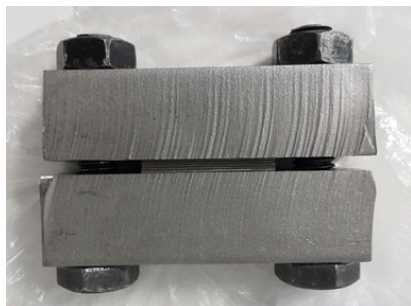
شکل ۱- نمونه های قرار گرفته داخل فیکسچر
