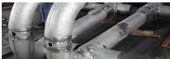
شکل ۱- همجواری جوش‌ها در لوله کشی
