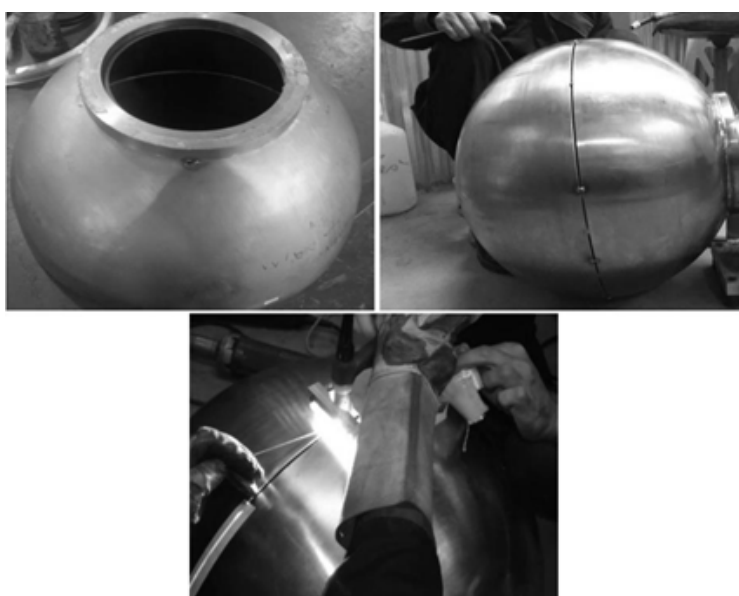
شکل ۳- الف - مونتاژ فلنج نازل و جوشکاری فلنج نازل در مرحله اول (بالا سمت راست) جفت کردن دو نیم کره در کنار هم آماده سازی قبل از جوشکاری (بالا سمت چپ) و انجام فرایند جوشکاری (پایین) آزمون هیدرواستاتیک
