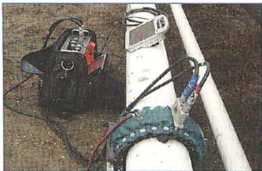
شکل ۴- مثالی از وضع قرار گرفتن دستگاه آزمایش امواج هدایت شده، که نشان دهنده نصب رینگ قابل تنظیم بروی لوله
