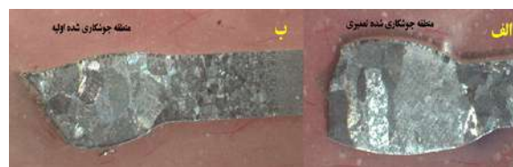
شکل ۱۴- تصویر رشد دانه ها در الف - منطقه جوشکاری تعمیری قطعه نسبت به ب - منطقه جوشکاری اولیه.
