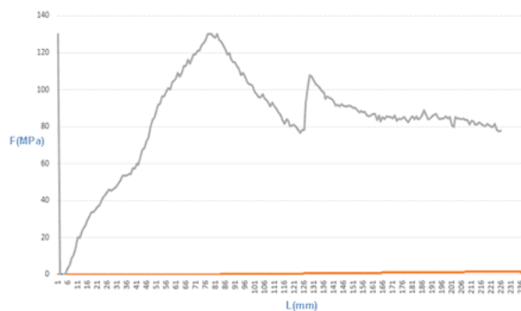
شکل ۱۲- آزمون کشش برای نمونه A
