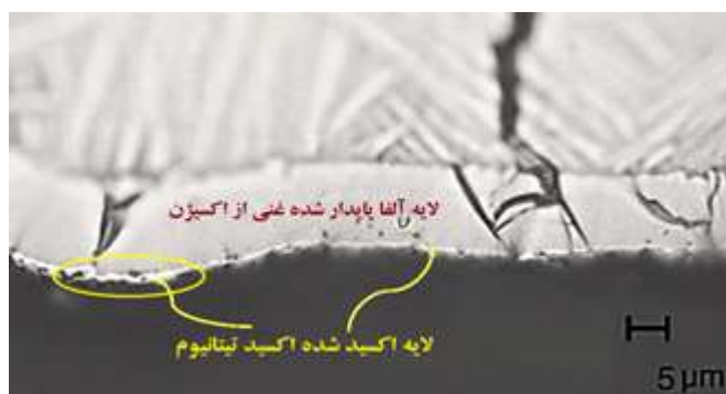
شکل ۱۰- تصویر تشکیل لایه سفید و ترد \alpha پایدار شده به وسیله اکسیژن در سطح خارجی و لایه بسیار نازک اکسید تیتانیوم
