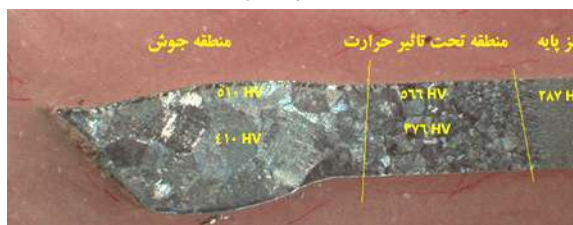
شکل ۱۵- تصویر اندازه دانه ها در قطعه، در منطقه ای که تحت تاثیر حرارت ناشی از تعمیر جوش قرار نگرفته است.
