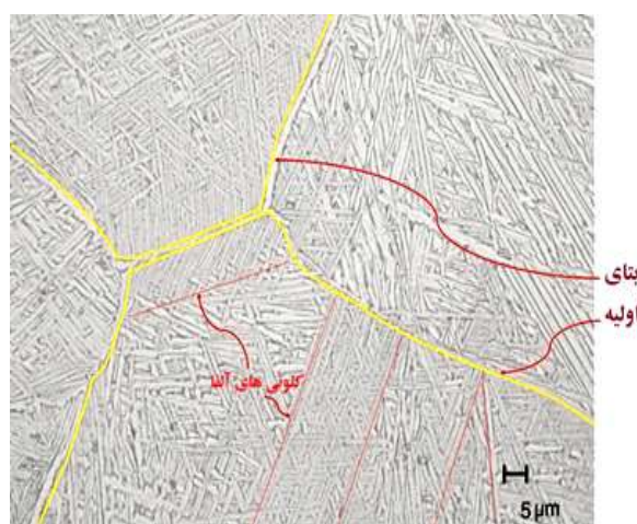
شکل ۱۳- ساختار منطقه HAZ از β اولیه تبدیل شده به فاز α سوزنی محصور شده با β.
