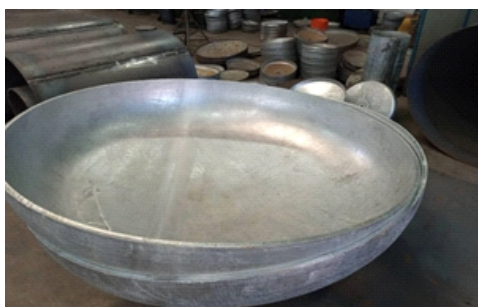
شکل ۳- عدسی مخزن تحت فشار مورد مطالعه در این تحقیق.
