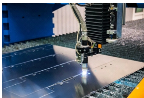
شکل ۲ - برشکاری پلاسمایی آلومینیوم با استفاده از سیستم CNC
