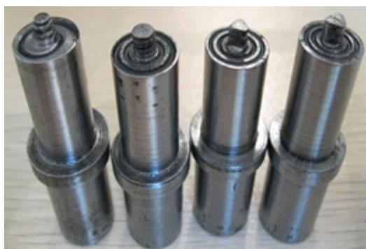
شکل ۳- تصویر چهار ابزار استفاده شده برای ارزیابی تاثیر هندسه ابزار بر کیفیت جوش (الف - مثلثی ساده، ب - مثلثی شیار دار، ج - استوانه شیاردار، د - مخروط شیاردار)
