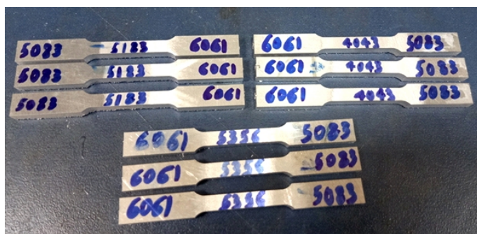
شکل ۳- تصاویر نمونه‌های آزمون کشش عرضی جوش‌های حاصل از سه سیم جوش متفاوت.
