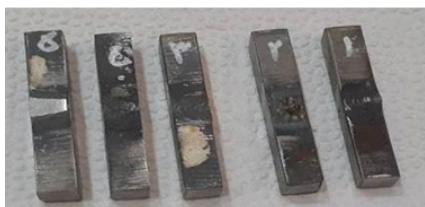
شکل ۳- الف- ابعاد نمونه ضربه شاری (برحسب میلی‌متر)، ب- تصویر نمونه‌های آماده سازی شده.
