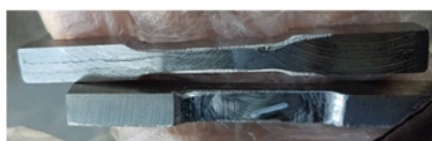
شکل ۲- الف- ابعاد نمونه آزمون کشش براساس استاندارد ASTM E8 (برحسب میلی‌متر)، ب- تصویر نمونه‌های آماده سازی شده.
