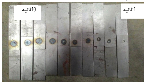
شکل ۱۳- اثر زمان جوشکاری بر منطقه متاثر از حرارت HAZ.
