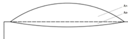
شکل ۶- شماتیک سطح مقطع لایه پوششی و ذوب شدگی زیر لایه [۱۸، ۱۷].
