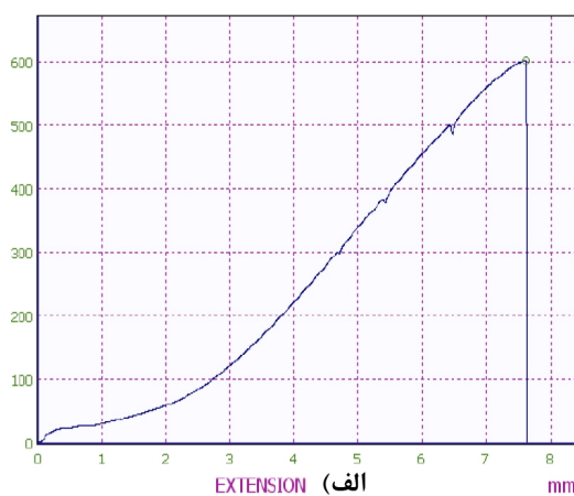
شکل ۷- استحکام کششی دو نمونه اتصال TLP فولاد 15PH-5 در دمای ۱۱۵۰ °C: الف- زمان ۵ min ، ب- زمان ۳۰ min.
