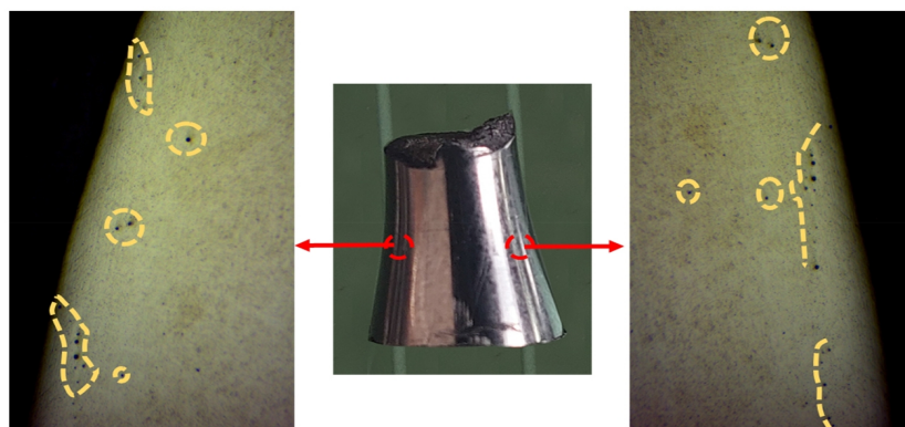
شکل ۸- تخلخل‌های نزدیک سطح نمونه خستگی
