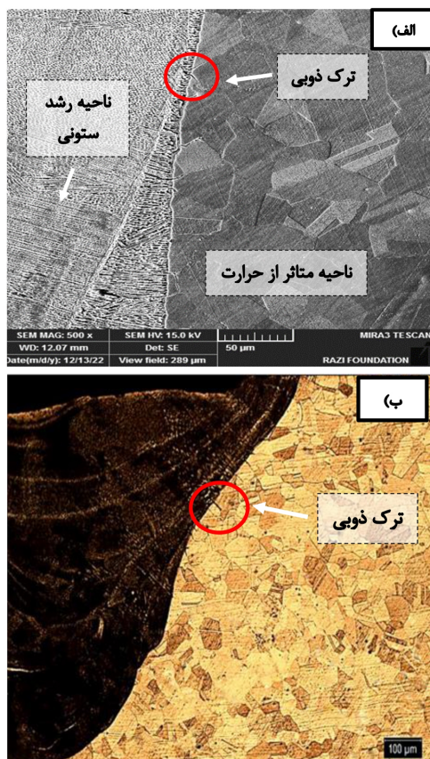
شکل ۳ - ریزساختار فلز پایه، منطقه متأثر از حرارت و ترک ذوبی نمونه شماره ۵.
