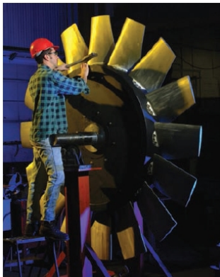
شکل ۴- جوشکاری پره ها به محفظه توربین
