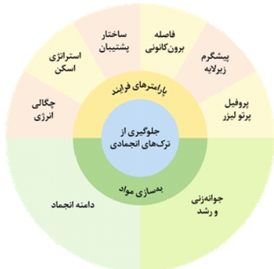
شکل ۱- جنبه‌های کلیدی برای جولوگیری از ترک‌های انجمادی آلایزهای آلومینیوم استحکام‌بالا حین ساخت افزایشی با روش LPBF [6].
